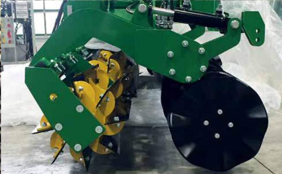
Un vérin hydraulique permet de faire varier la pression sur les disques gaufrés et les rouleaux hélicoïdales.
