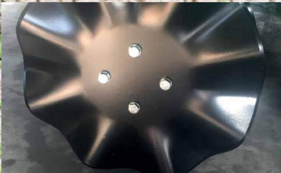
Les disques gaufrés ont un diamètre de 400 mm et un pas de 150 mm.
