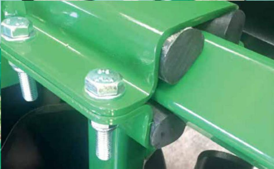
Le X-Cut Solo dispose d'une double sécurité contre les pierres. Les rouleaux hacheurs hélicoïdales et la rangée de disques gaufrés sont montés sur un système de silent bloc.
