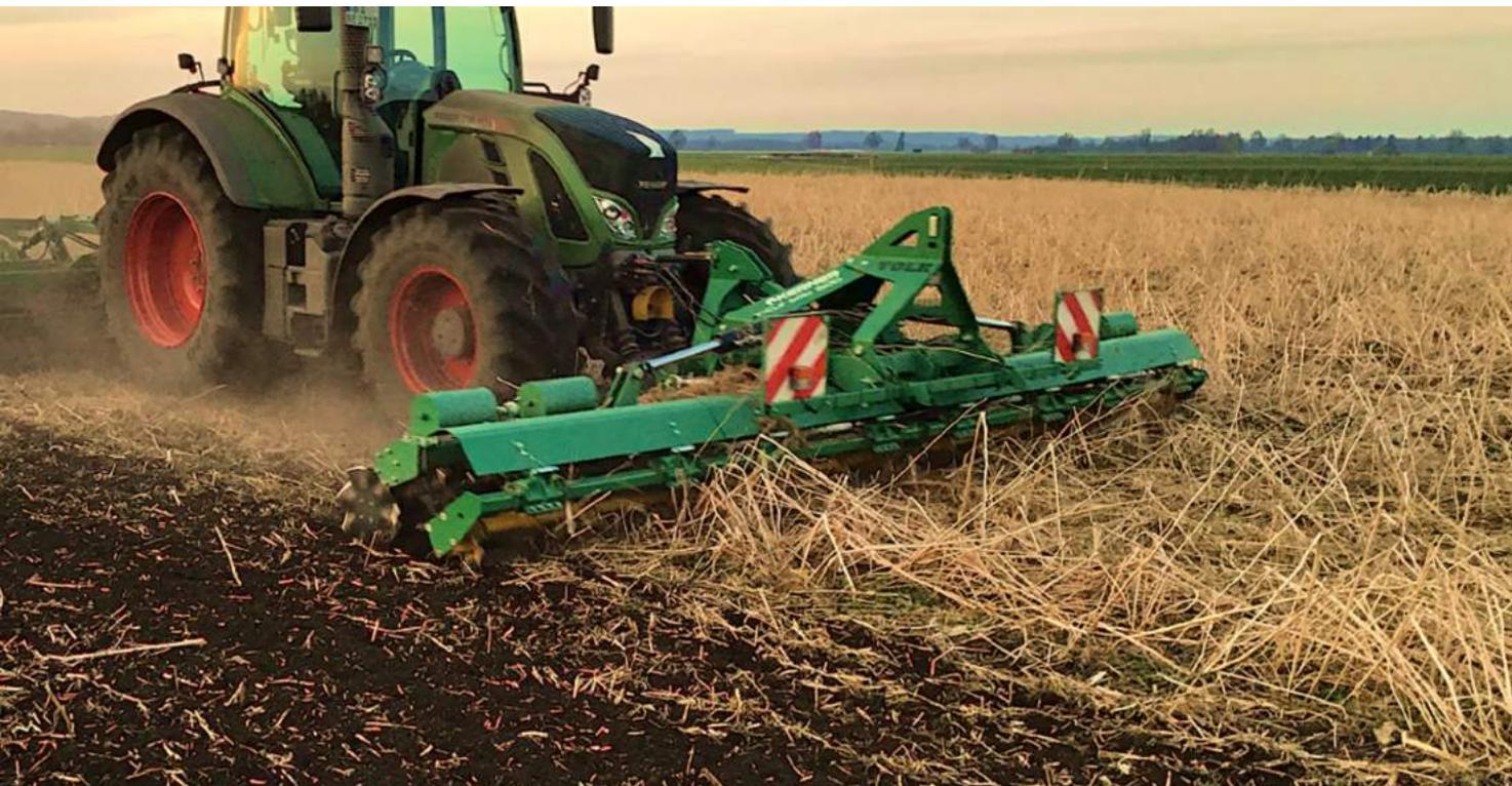
Le rouleau hacheur **X-CUT** est une combinaison entre un rouleau hacheur et des disques broyeurs avec réglages de la profondeur de travail.
