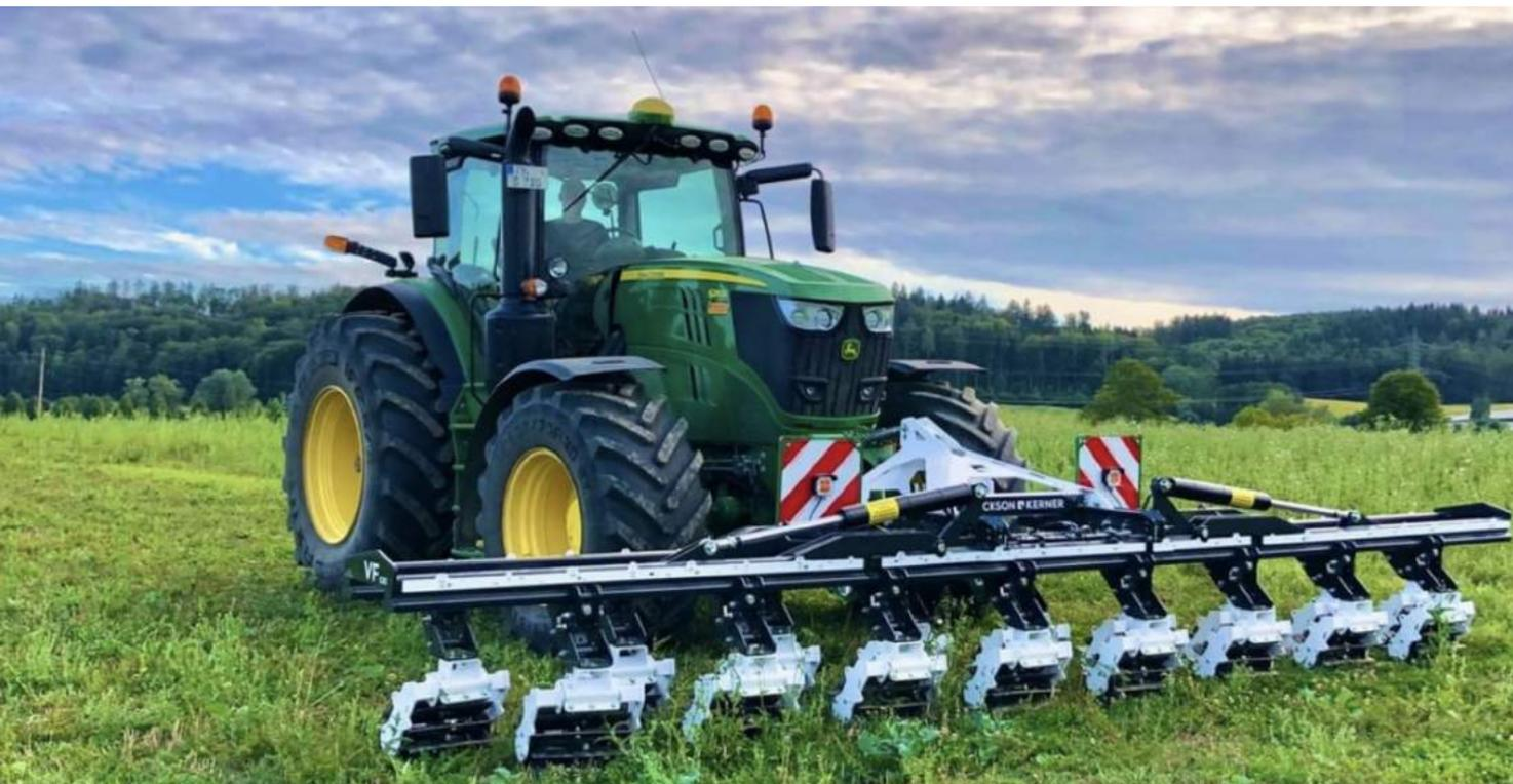
Le **VARIOFIELD** peut être équipé de rouleaux hacheurs qui travaillent sur toute la largeur de la machine et hachent des couverts végétaux, des pailles, des pieds de maïs pour lutter contre la pyrale et effectuer des faux semis, etc...
