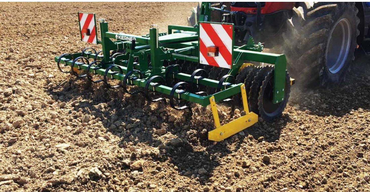
Le **FRONTPACKER** répond aux attentes des professionnels de l'agriculture. Il est composé d'un rouleau et d'un outil de préparation du sol. Le large choix d'outils et de rouleaux permettent aussi bien de travailler en conditions humides ou pierreuses et sur sols légers ou durs.
