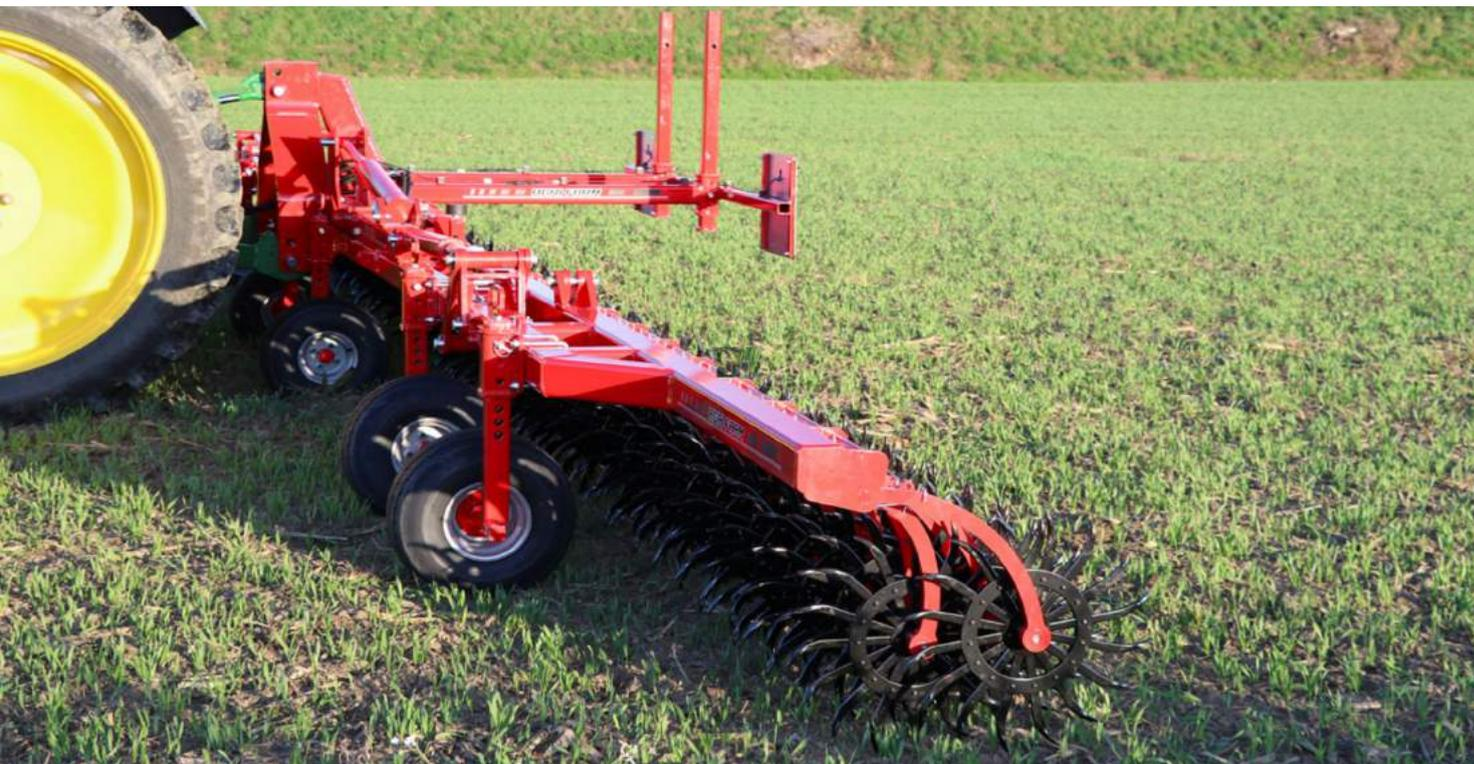
La **BIO PLUS** est une houe rotative avec des étoiles de diamètre 540 mm. Le montage d'une étoile par bras, sur 2 rangées, suit parfaitement le sol grâce à son système de tension à ressort et évite le blocage dû aux pierres. L'écartement de 8.4 cm permet d'effectuer un travail sur toute la surface.
