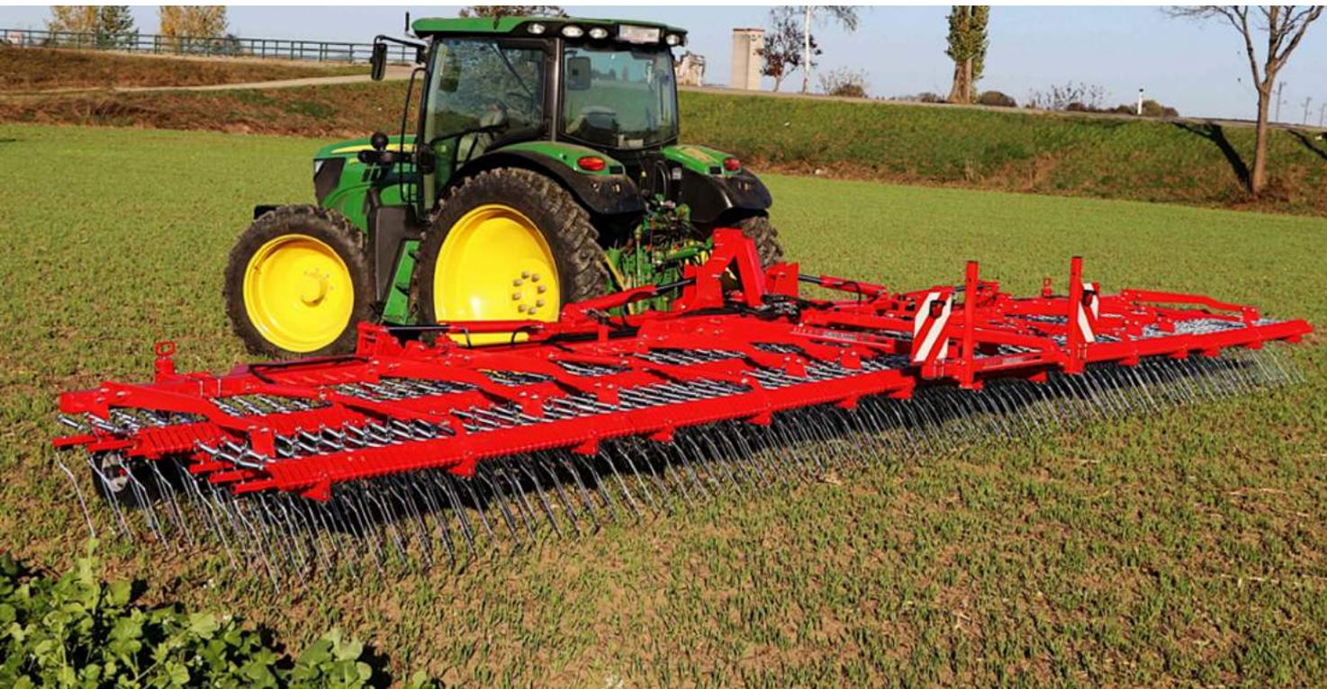
La **BIO PROFI** est une herse étrille équipée de dents diamètre 8 mm, longueur 530 mm avec une fixation qui assure une tenue latérale en ligne et un suivi parfait du sol grâce à son système de tension.
