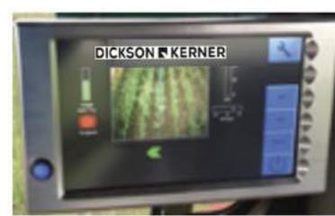
Le système de guidage **TILLET** dirige de façon très précise la bineuse à différents stades de la culture et jusqu'à 15 km/h.
