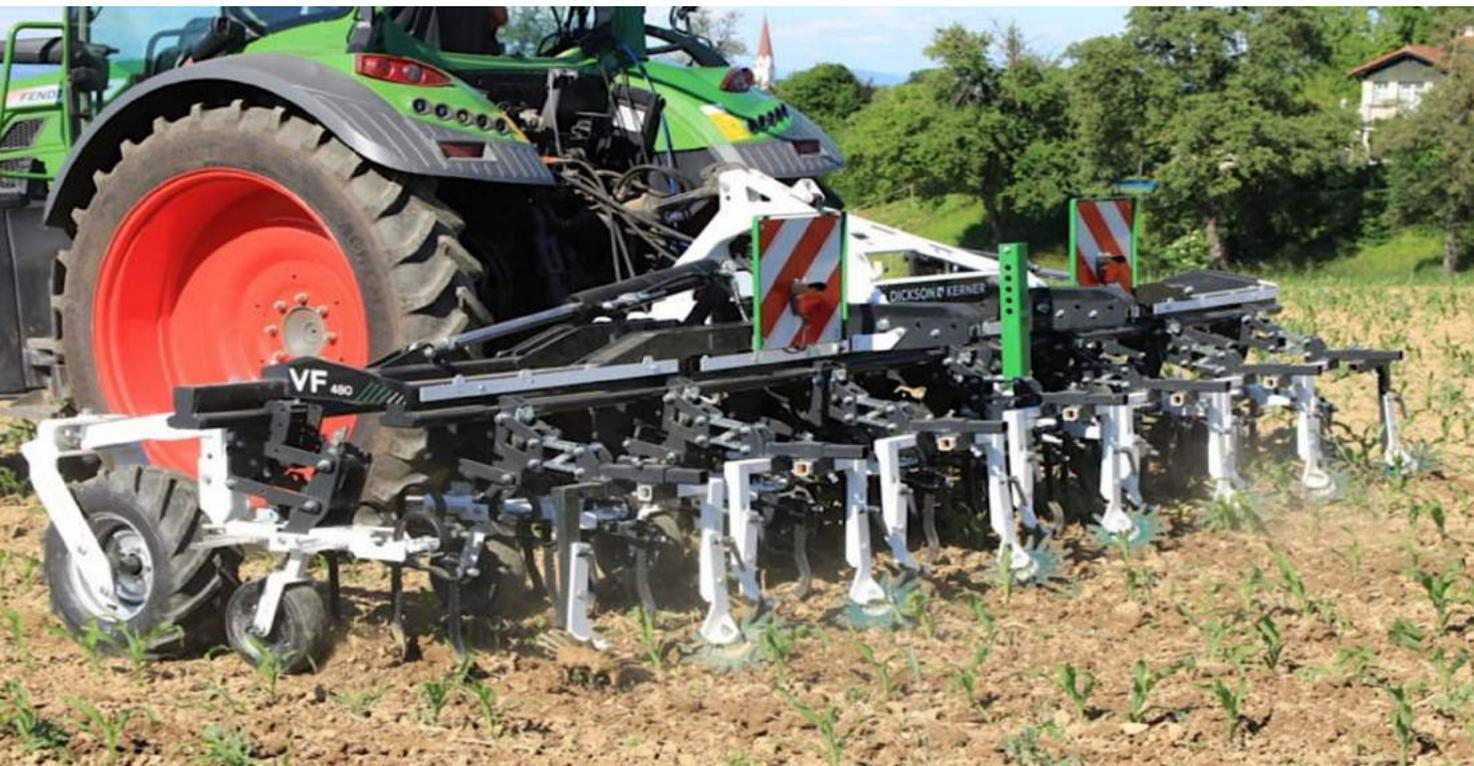
La bineuse **VARIOFIELD** est plus qu'une bineuse classique. Elle scalpe les adventices en remuant peu de terre grâce à la forme optimisée des parallélogrammes, des socs et des dents.
